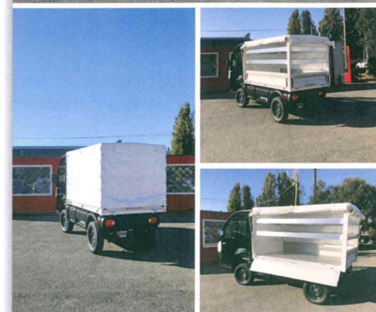
Foto: Cassone con centina fissa, pianale in alluminio mandorlato, sponde in TR1 e telone in PVC ignifugo di colore bianco. Allestimento veicolo cliente Exelentia per "Città del Vaticano".
